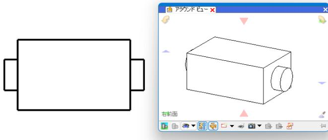
2 接続口と基準点を一直線上に配置するため、[図形]タブ-[仮線]で3Dとして登録する図形上に仮線を作図します。
