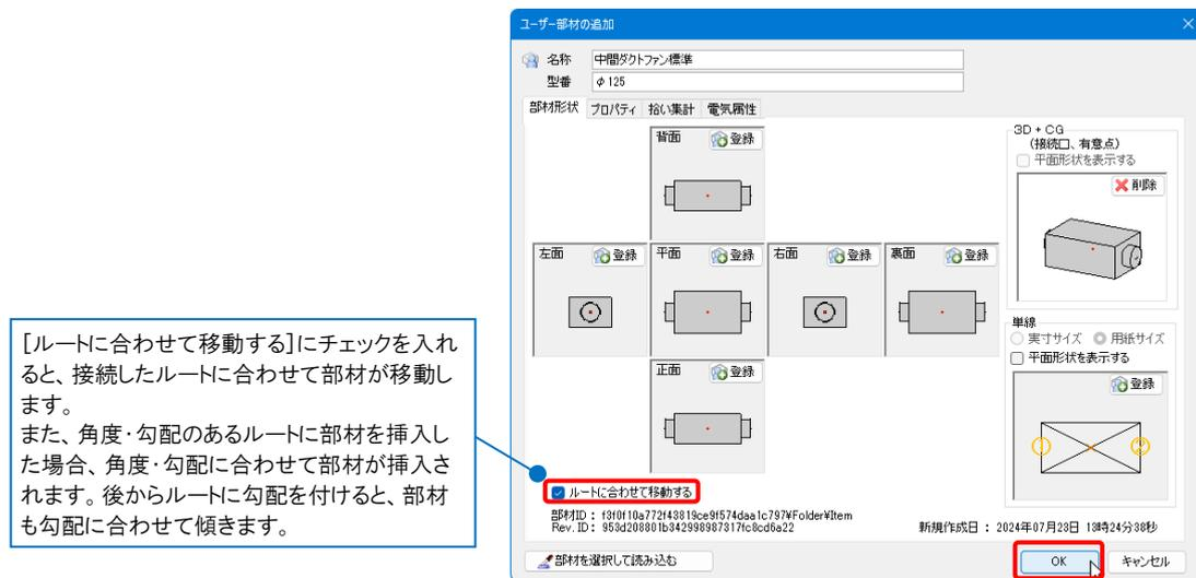
[ユーザー部材の配置]で、ルート上に挿入できるようになります。
