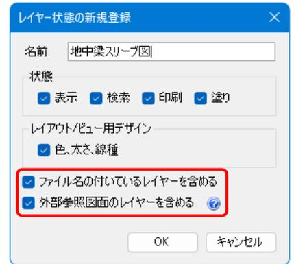
[外部参照図面のレイヤーを含める]にチェックを入れると、外部参照図面のレイヤーも状態の登録を行います。外すと外部参照図面のレイヤーの状態は登録しません。
