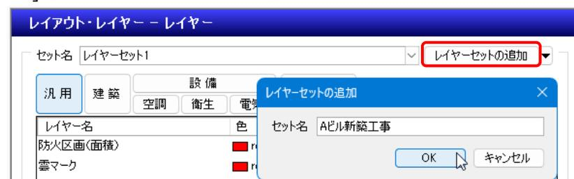
[レイヤーセットの追加]横の[▼]から[レイヤーセットの複写]をクリックすると、「セット名」で指定しているレイヤーセットを複写します。複写したレイヤーセットのレイヤーの内容を編集して登録できます。
