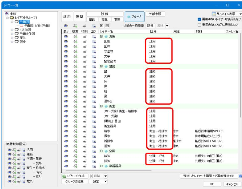
[配管][ダクト][電気]ルート作図のコマンドは選択する区分が設備関連に絞られます。
