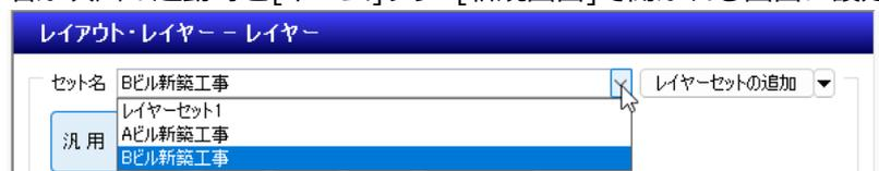
レイヤーセットは、[レイヤーセットの追加]をクリックして新規作成できます。
