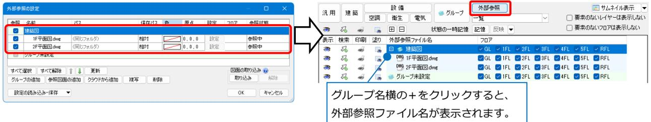
[一覧]をクリックすると、参照しているファイル名の一覧を表示します。ファイル名を選択すると、レイヤー選択エリアに外部参照ファイルのレイヤーを表示します。
