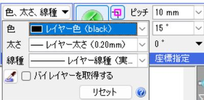
作図コマンドのリボン[色、太さ、線種]で「レイヤー色」「レイヤー太さ」「レイヤー線種」にすると、バイレイヤーとなり、レイヤーに設定された色、太さ、線種で作図します。
