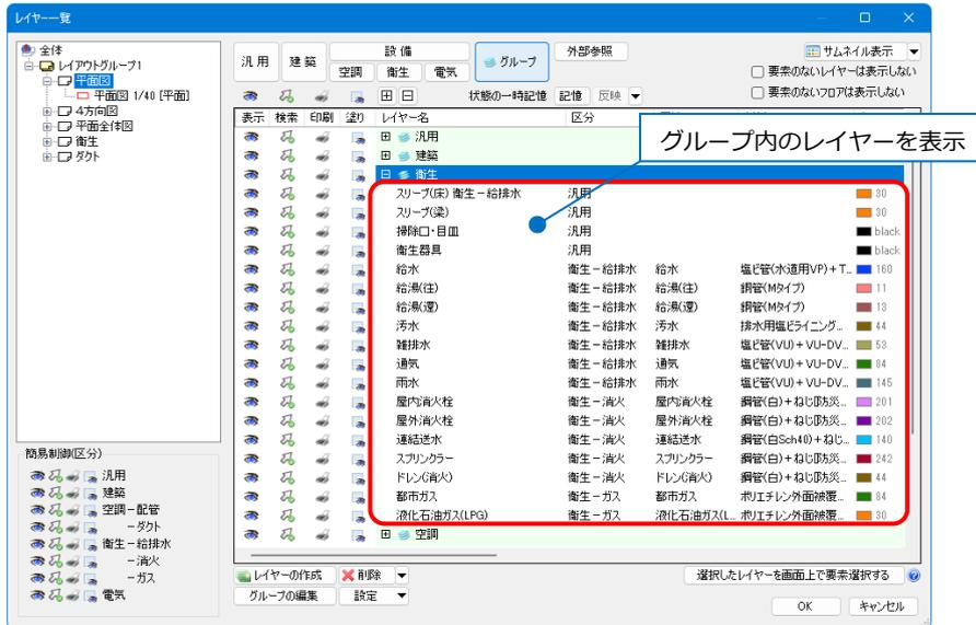
[配管][ダクト][電気]のルート作図のコマンドは、「設備」分類のレイヤーが所属しているグループに絞られます。
