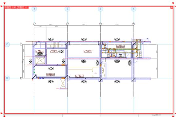
レイアウト「ダクト」 ダクト系統と空調設備を表示
