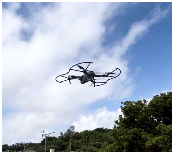
接触事故対策としてプロペラガードの装着
